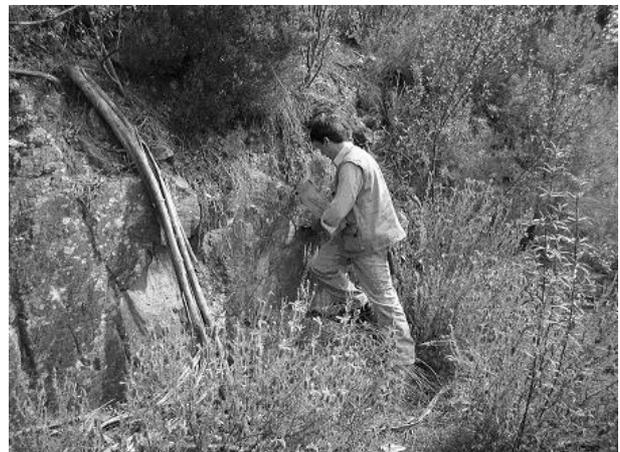
Figura 2 – Medição da atitude (inclinação e direcção) com bússola
