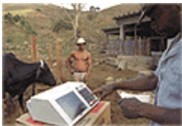
A urna, parecida com as caixas automáticas dos bancos<sup>14</sup> mas de menor dimensão, é constituída por um monitor e um teclado numérico. Cada caixa tem no seu interior um cartão de memória do tipo Flash Card com o software de votação e uma disquete com a informação de todos os candidatos no local.
